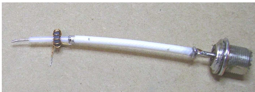
Photo 4: Tore monté sur le coaxial du côté du commutateur
